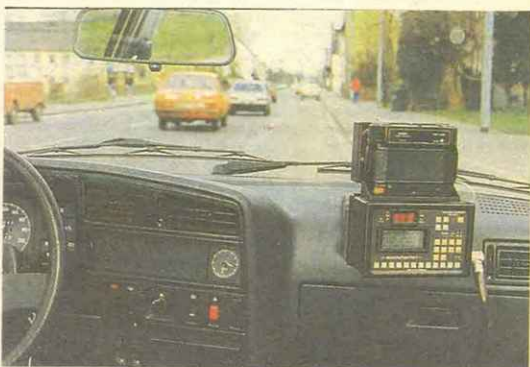
Прибор для контроля скорости «Спидофот» можно установить не только в полицейском автомобиле (см. фото), но и на штативе.
