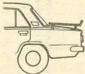
Рис. 1. Грузовая платформа на крышке багажного отсека.
