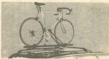
Рис. 3. Багажник для велосипеда: комбинация продольных опор на крышке универсала, закрепленных на них поперечины и специальных кронштейнов.
